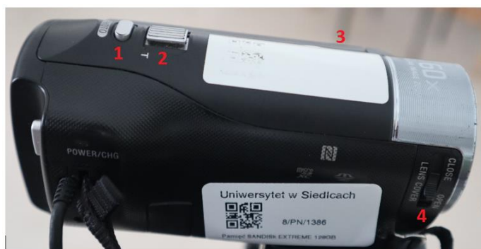
32. Cyfrowa kamera wideo 2 : 1 przycisk PHOTO do ustawiania ostrości, 2 regulacja zbliżenia, 3 składany monitor LCD, 4 osłona obiektywu
